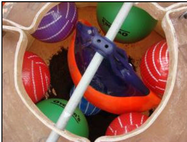
Vista del interior del molde armado con boya central Y pelotas
