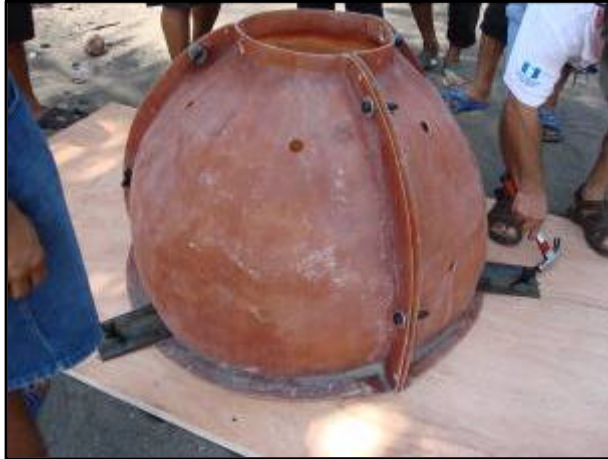
Vista de moldes armados, se puede observar el sistema de anclaje
