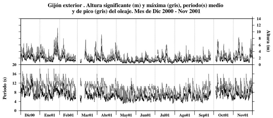
Figura 4.2: Series brutas. Altura y periodo del oleaje.
